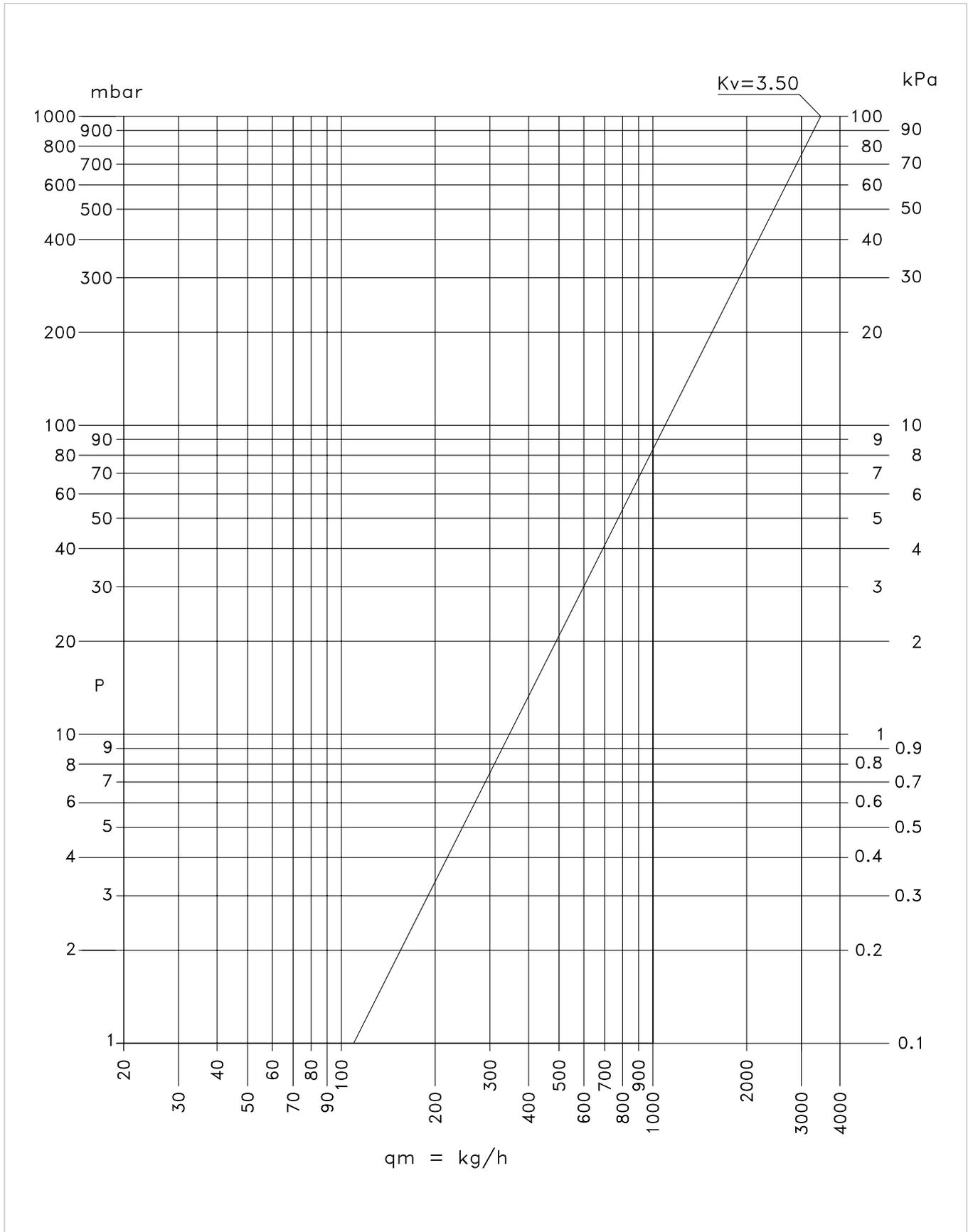
Di seguito il diagramma delle perdite di carico della valvola deviatrice in posizione tutta chiusa, presente nei kit V30361, V30662.
